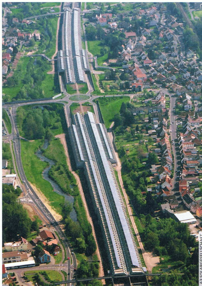
Durch Bürgerbeteiligung finanziert und akzeptiert: Die vermutlich längste Solaranlage der Welt auf der Autobahneinhausung der A3 im unterfränkischen Goldbach-Hösbach.
